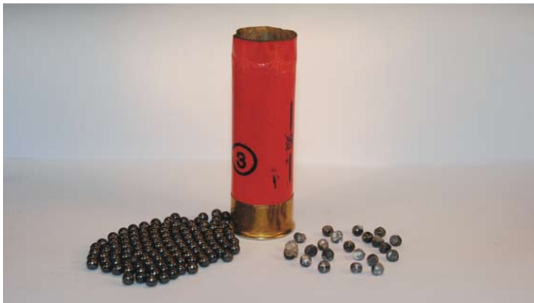
Fig. 4. Bilden visar en hagelpatron där blyhagelladdningen tagits ut. Hela laddningen av blyhagel ligger till vänster om patronen på bilden. Till höger om patronen ligger deformerade hagel efter en träff i telefonkataloger. Notera den oregelbundna formen hos de använda haglen vilket tyder på att delar av haglet saknas dvs det har bildats fragment.
