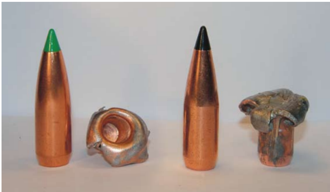
Fig. 1. Bilden visar två kultyper innan och efter att de skjutits i en blandning av uppblötta och torra telefonkataloger på nära håll, vilket ger ett realistiskt test av en kulas förmåga att hantera en bogträff på större klövvilt. Kulan till vänster är ickebondad och den till höger är en medelhård bondad kula. Kulorna har från början samma vikt och är expansionskjutna i samma hastighet med .308 Win. Manteln på den vänstra kulan har hållit ihop, men blykärnan har splittrats och delarna (fragmenten) har lossnat från manteln. Restvikten är 44 %. Vid tillverkningen av den högra kulan har blyet förenats med manteln, vilket ger en kontrollerad expansion med betydligt mindre blysplitter. Restvikten är 92 %. I båda fallen är kulorna tillverkade med en aerodynamisk plastspets, som inte deformeras lika lätt som bly. Manteln är dock fortfarande öppen framtill, och därmed är kulorna halvmantlade.
