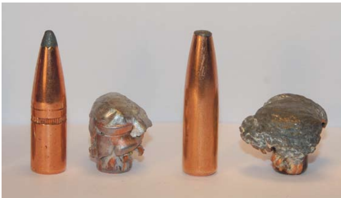
Fig. 2. En ickebondad blykula med mekaniskt blyläs (vänster) och en mjuk bondad kula (höger) skjutna med .308 Win. Det mekaniska blyläset har förhindrat att den vänstra kulan expanderat längre än till läset, som finns innanför den övre synliga "ringen" på kulan. Blykärnan i spetsen av kulan har däremot splittrats, och restvikten är 78 %. Den mjuka bondade kulan till höger har hållit samman väl trots att den expanderat till en stor diameter, och har en restvikt på 96 %.
